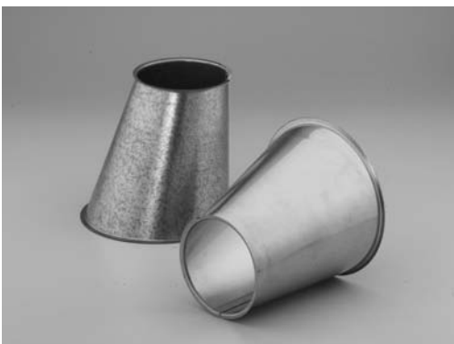
Fig. 3. Reduccions còniques obliqües de bases paral·leles, utilitzades com a elements d'unió intermèdia entre dues peces de diferent diàmetre. D'aplicació general en conductes de captació de pols i en especial en canones de transport pneumàtic de materials i partícules. 1
