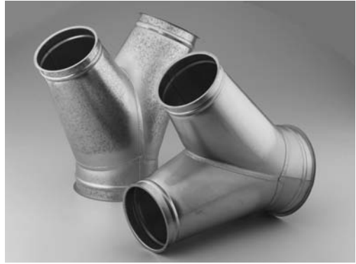
Fig. 6. Entroncaments pantaló. Intersecció simètrica de dos conductes cònics rectes d'igual diàmetre i eixos secants, formant un angle de 60°. Sortida superior central cilíndrica de diferent diàmetre. D'aplicació en xarxes de canonades de captació de pols i transport pneumàtic. 2
