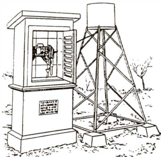
El pluviògraf d'intensitats del Dr. R. Jardí permeté de mesurar la intensitat momentània de la pluja, és a dir, la quantitat d'aigua que cau per minut, servint de partença per al càlcul de les canalitzacions d'aigües fluvials, tant de les ciutats com dels camins i en ple camp
