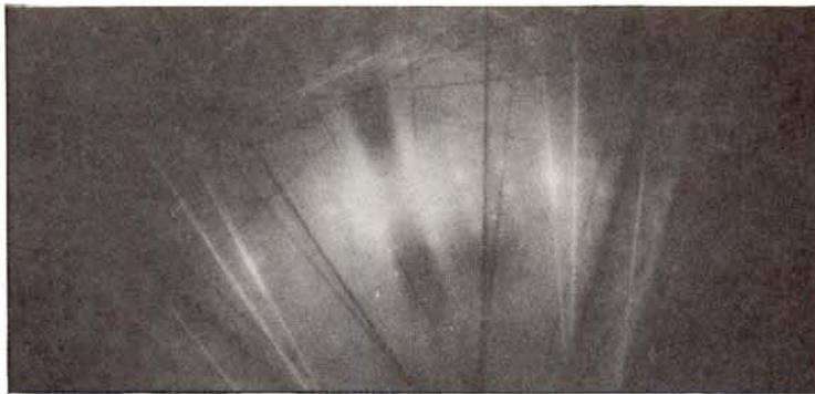
Diagrama de difracció d'una pel·lícula d'or depositada sobre NaCl (clorur de sodi).
