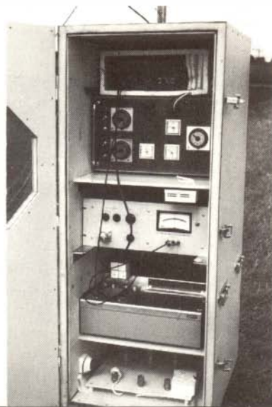
Integrador per a la mesura de la radiació solar i de l'albedo per a ús en l'experimentació de la producció agrària
