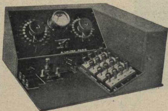
Fig. 68.—Aparell per a determinació de la cronàxia (Walter)
