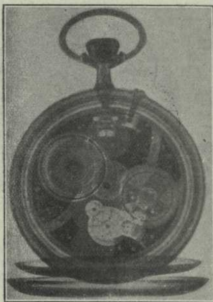
Fig. 17 Radiografia d'un rellotge en tamany natural, sense pel·lícula de reforç. 70 kV i filtre de 2 mm de llautó
