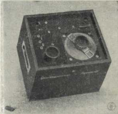
Fig. 1a. Aparell mesurador de la sobretensió tancat.
