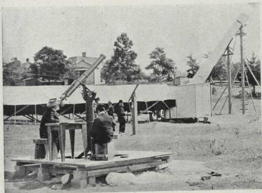
Ullera equatorial instal·lada per a l'observació d'un eclipsi solar
