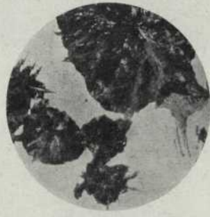
Fig. 12 Els nòduls de troostita han anat creixent en forma esfèrica i alguns estan deformats per interferències d'altres grans. Gravada amb àcid picric. Augment, 1160 diàm. (2220)
