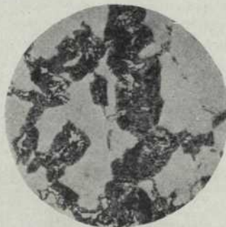
Fig. 2 Secció longitudinal d'una mostra d'acer comercial amb 0,5 % de carboni. Dimensions: 25 x 10 mm. Augment, 2'2 diàmetres (5 1/2). 5 Transformació de l'austenita i martensita d'aquest acer a perlita laminar
