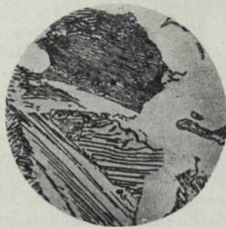
La troostita és estratificada. El fons es de ferrita lliure. Gravada amb àcid picric. Augment, 1700 diàm. (3230)
