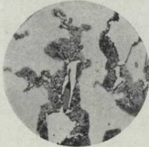
Fig. 5 Ací la troostita ha disminuït considerablement, per donar lloc a la formació d'àrees de ferrita lliure. Noti's sobre el fons d'austenita i martensita l'aparició de petits punts foscos, els quals marquen el començament de la precipitació de la ferrita. Gravada amb àcid picric. Augment, 1700 diàm. (3230)
