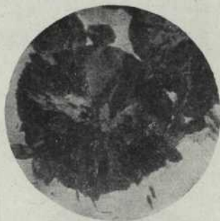
Fig. 13 Nòdul troostític ben format. S'ha desenrotllat com una massa granular al voltant d'un nucli. Al centre apareixen petites àrees de ferrita lliure. Gravada amb àcid picric. Augment, 1700 diàm. (3230)
