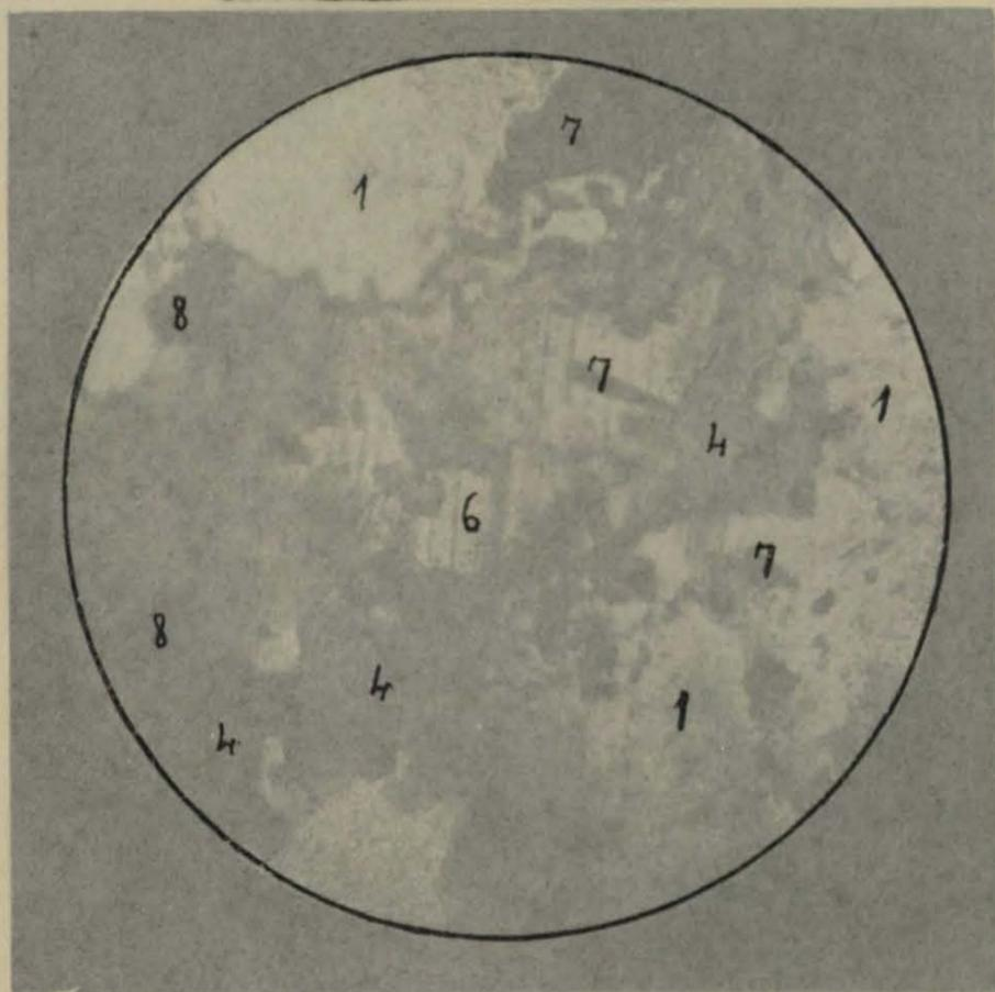
Fig. 8. — Sienita del torrente del Oeste del cementerio de Teyà. L. ord. 40 d. prep. n.º 26 col. M. San Miguel. 1 feldespato. 4 clorita. 6 calcita. 7 esfena. 8 magnetita
