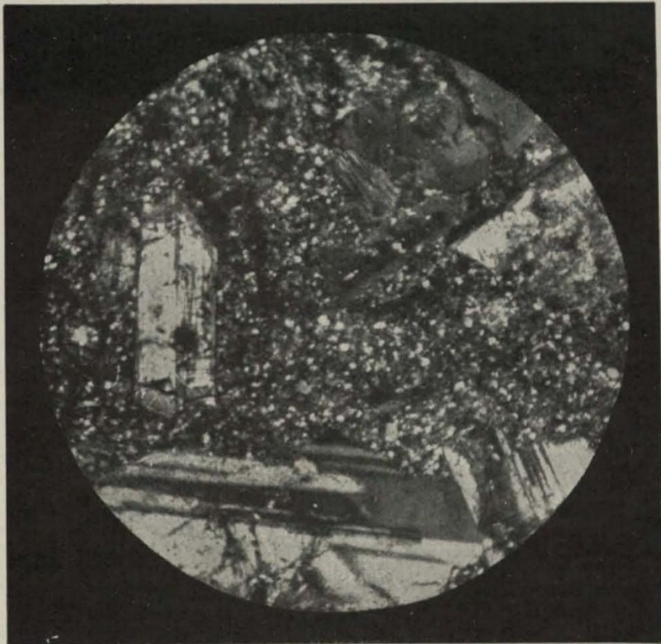
Fig. 29. — Pórfido granítico de las canteras de Casa Bru. N+40 d. prep. n.º 93 col. M. San Miguel. 1 oligoclasa. 4 biotita. 8 magnetita. 1-2-4 pasta microgranuda de feldespato, cuarzo y biotita
