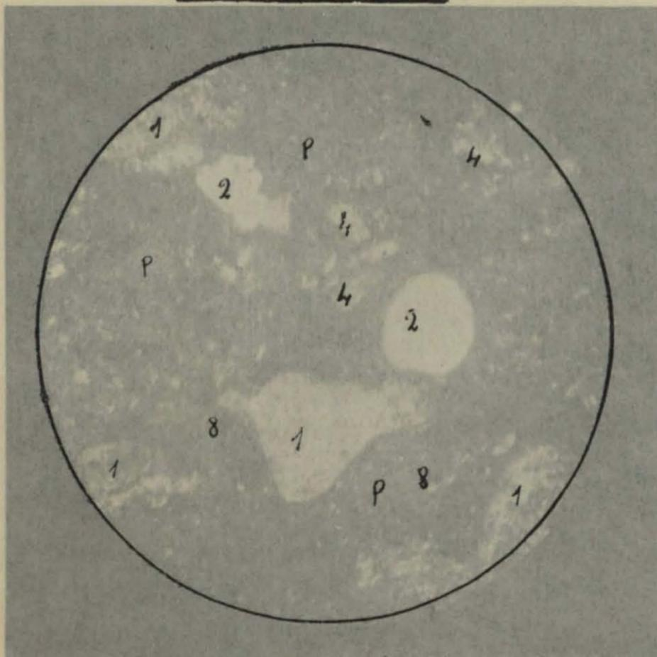
Fig. 40. — Pórfido cuarcífero (microgranito) del coll de can Gorgui, lado del Vallés. N+20 d. prep. 122 col. M. San Miguel. 1 feldespato alterado, 2 cuarzo, 4 biotita, 8 magnetita. P pasta micr**40**anuda con base felsítica
