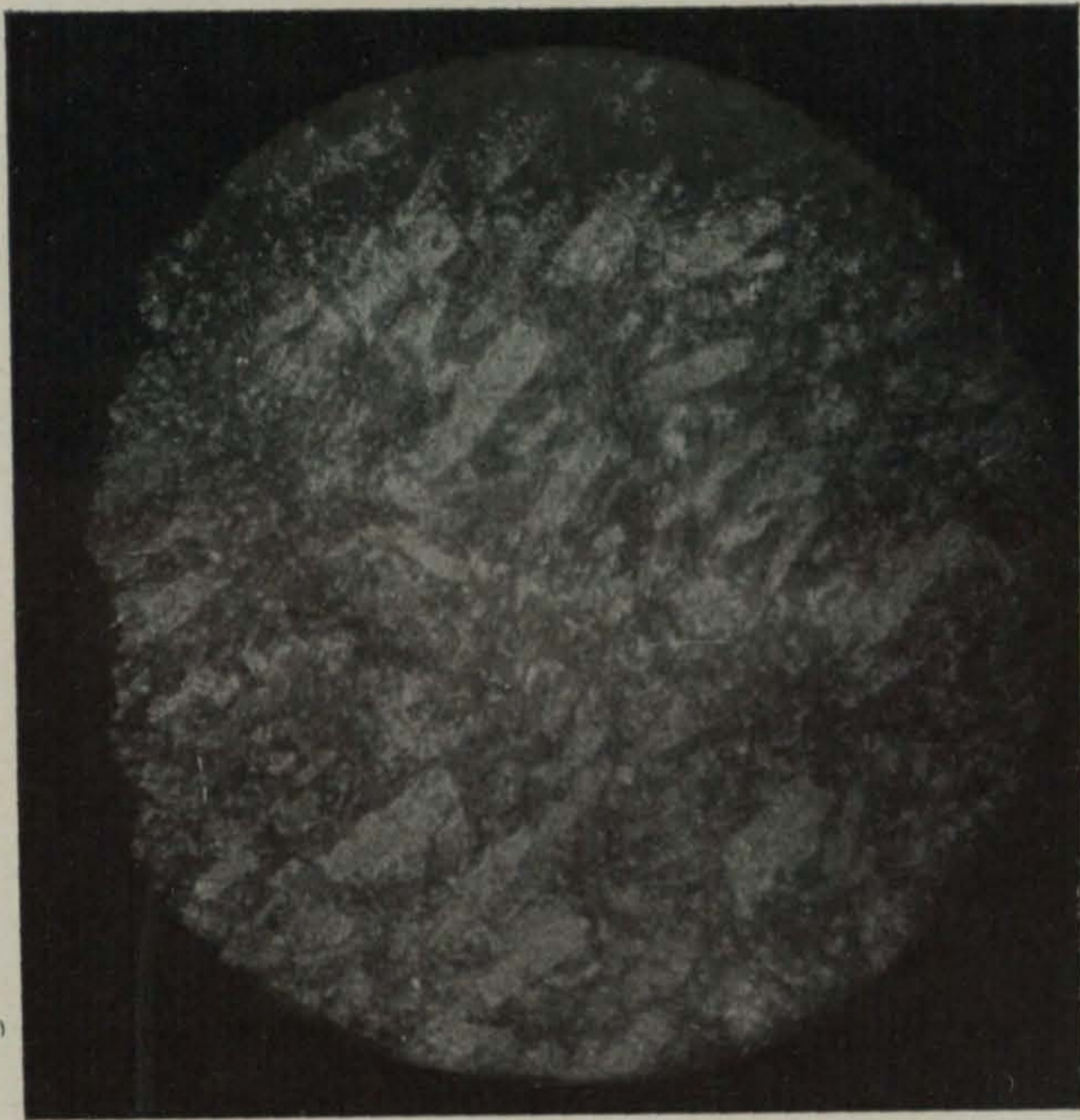
Fig. 35. — Porfiritas andesíticas del cerro del Cementerio. N+. 50 d. prep. n.º 242 col. erup. Cataluña M. San Miguel. 3 feldespato alterado. 3-7 pasta de feldespato y clorita ◀ (Microfot. M. San Miguel)
