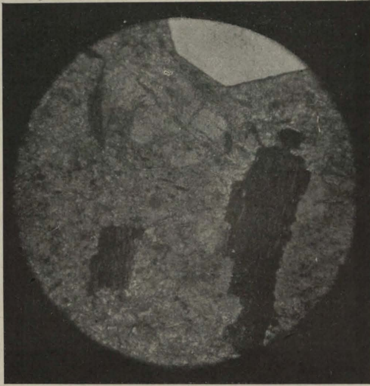
Fig. 24. — Pórfido granítico de la Riera de Caldetas. luz ord. 50 d. prep. n.º 130 col. erup. Cataluña M. San Miguel. 1 cuarzo. 2 feldespato. 5 biotita. 1-2-4 pasta microgranuda de cuarzo, feldespato y biotita (Microfot. M. San Miguel)
