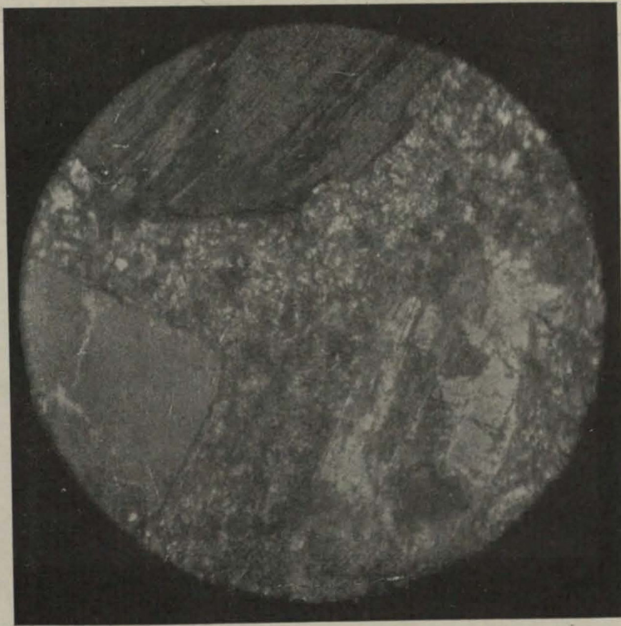
Fig. 25. — Pórfido granítico de la Riera de Caldetas. N+. 50 d. prep. n.º 130 col. erup. Cataluña M. San Miguel. 1 cuarzo. 2 feldespato. 5 biotita. 1-2-4 pasta microgranuda de cuarzo, feldespato y biotita (Microfot. M. San Miguel)
