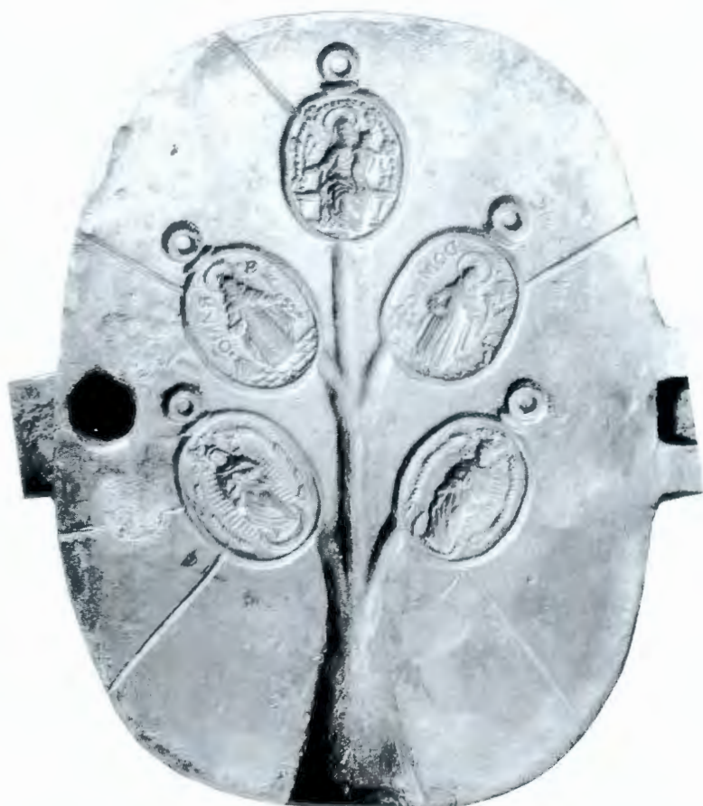
Fig. 3. Valva del motlle que origina els reversos. A dalt, el de la Mare de Déu del Roser; a sota, un amb Sant Domènec i un altre amb Sant Ramon; i a baix, dos amb la Puríssima. La fotografia és a mida real.
