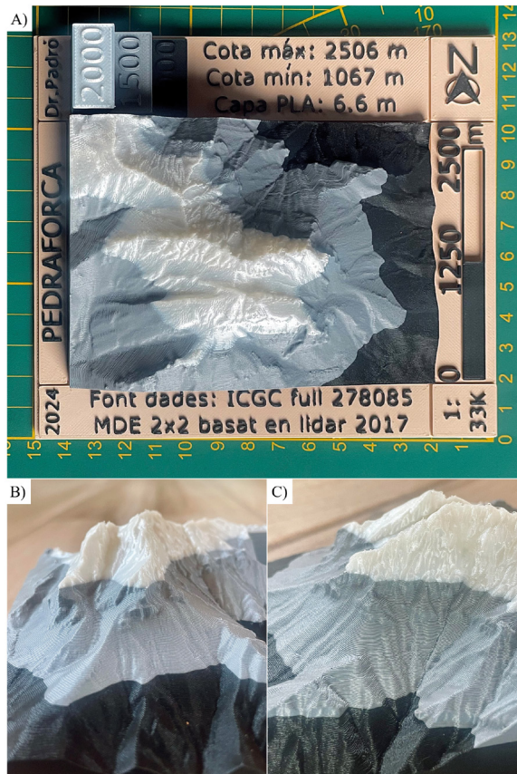
Figura 17. Materialització del MDE del Pedraforca en impressió 3D (versió amb simbolització hipsomètrica negre-gris-blanc a intervals de 500 metres)
