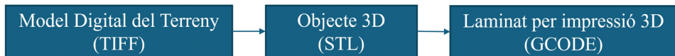
Figura 2. Formats de dades habituals per passar d'un MDT en el format típic de SIG a una figura impresa per control numèric
