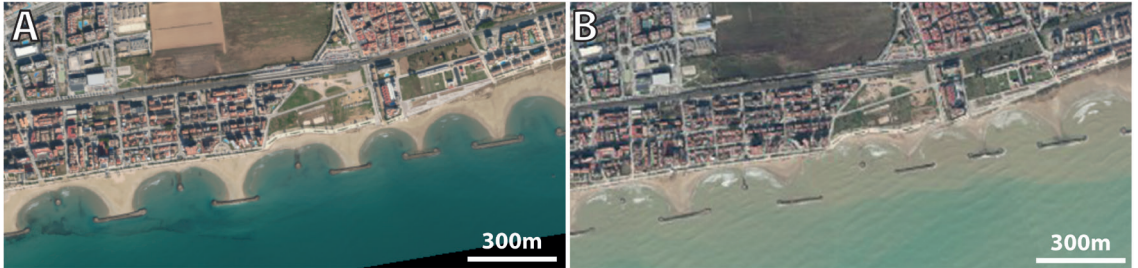
Fig. 5. Platja de Cunit el febrer del 2019 (A) i després del temporal Glòria (B). Els espigons paral·lels a la costa formen un seguit de tómbols molt susceptibles als temporals de llevant.
