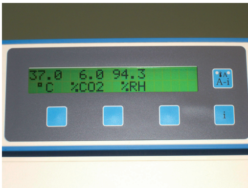
FIGURA 4. Pantalla d'un incubador, on s'indiquen les condicions estàndard de cultiu in vitro .
