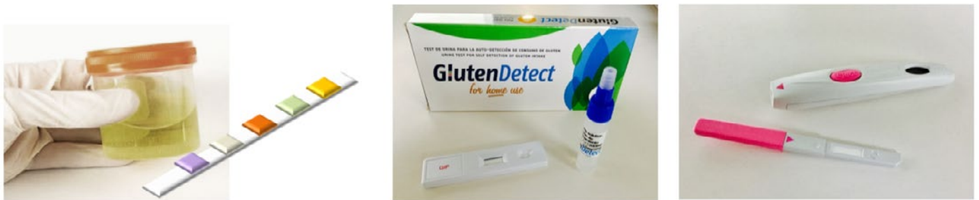
† Figura 1. Exemples d'assaigs en flux lateral per anàlisi d'orina, detecció d'ingesta de gluten (GlutenDetect, de l'empresa Biomedal SL Espanya) o test d'ovulació (Clearblue ® , de l'empresa SPD Swiss Precision Diagnostics GmbH, Suïssa).
