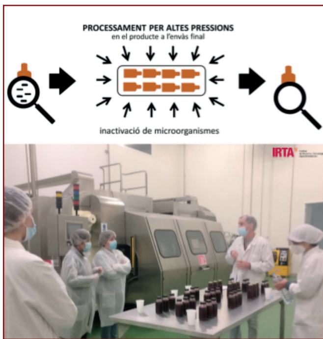
Figura 2. Equip de tractament APH i suc acabat de tractar a les instal·lacions de l'Àrea d'Indústries Alimentàries de l'IRTA a Monells ( https://youtu.be/CPS5T2oFbMA ).
