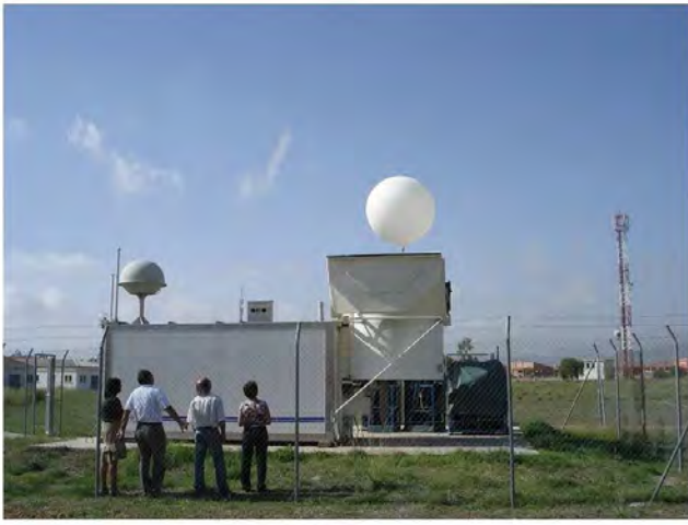
Figura 3: Estació de radiosondes actual de Palma. És totalment automàtica, no necessita cap tècnic per fer l'observació.
