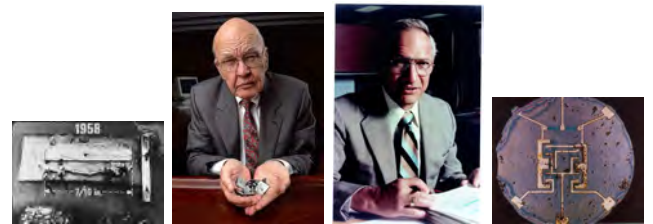
Figura 4: Primer circuit amb tots els dispositius de germani; Jack Kilby; Robert Noyce; Primer circuit integrat en un xip
