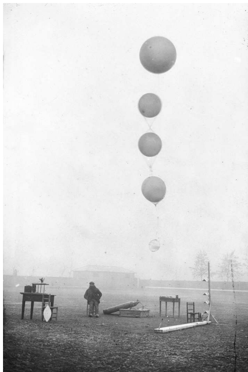
Figura 15: Llançament de globus captius per a l'estudi de les condicions de l'alta atmosfera. Fotografia conservada en el fons històric del Servei Meteorològic de Catalunya (ICC)
