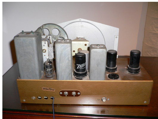
Figura 4: Vista interior d'una ràdio Zenith. (Foto: Enric Cabruja)
