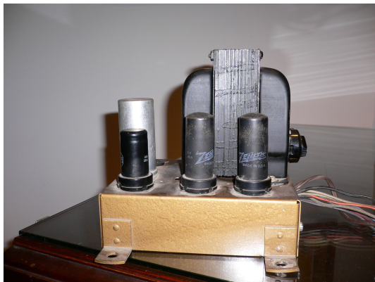
Figura 5: El transformador de l'alimentació de la mateixa ràdio. És la peça més gran i pesada. (Foto: Enric Cabruja)
