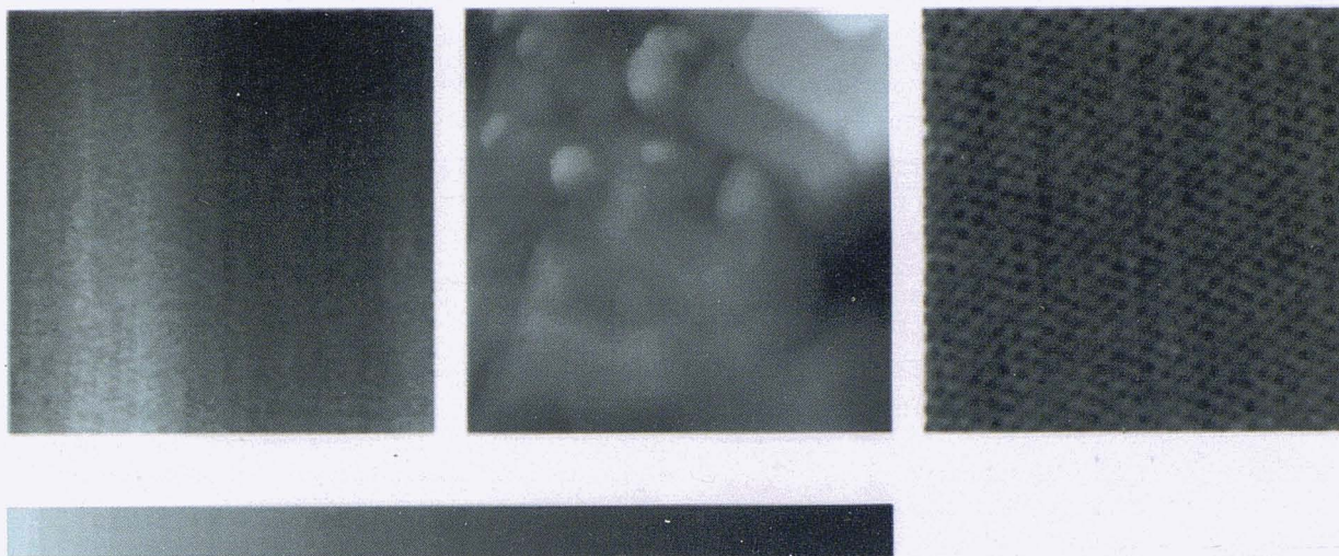
Figura 8: Imatges STM en medi líquid que mostren la deposició electroquímica de plata sobre grafit. La solució conté 0,1 M de \text{HClO}_4 i 5 mM de \text{AgClO}_4 . La primera foto, de 2000 \times 2000 \text{ \AA} , és presa a un potencial de la mostra de + 300 mV (respecte d'un elèctrode de Ag/AgCl), de manera que la \text{Ag}^+ no s'hi pot dipositar. La foto del mig, de les mateixes dimensions, ha estat presa just després de la deposició de Ag a - 100 mV, a un potencial de 0 mV. La darrera foto mostra la superfície de grafit després de canviar el potencial a + 300 mV, que ha causat la dissolució total del dipòsit de plata. L'estructura atòmica del grafit es veu clarament en aquesta imatge de 50 \times 50 \text{ \AA}
