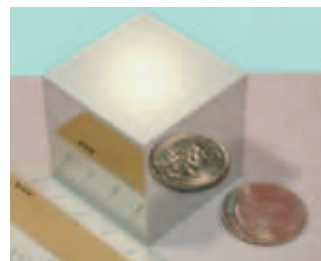
Figura 18: Masses test de platí i or. Fan el paper de miralls reflectint els raigs làser
