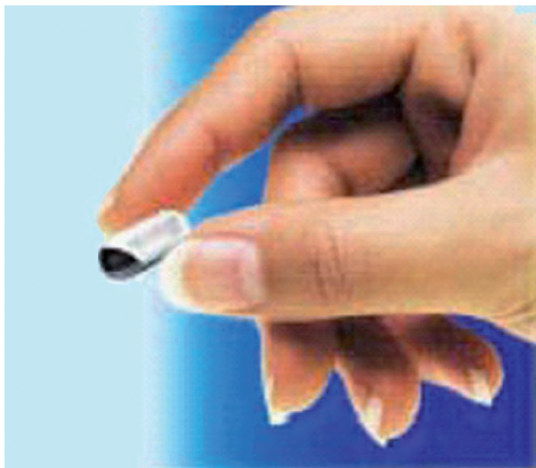
FIGURA 1. Càpsules ingeribles dotades de càmera de TV.
