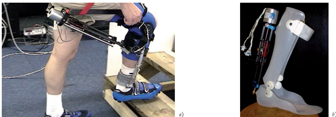
FIGURA 10. a) Exosquelet Yobotics RoboKnee (Pratt et al. , 2004) i b) ortesi activa de turmell (Blaya i Herr, 2004).
