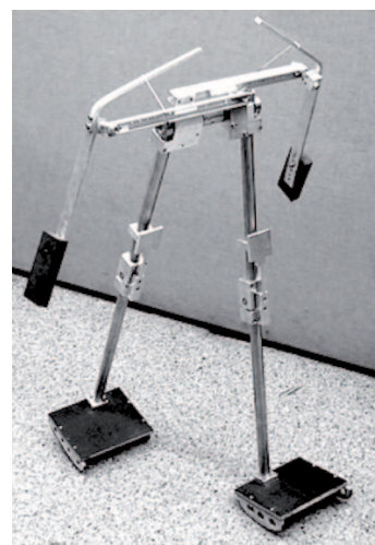
FIGURA 4. Mecanismes capaços de caminar pendent avall sense cap actuació ni control ( passive dynamic walking ): moviment bidimensional (a) i moviment tridimensional (b).
