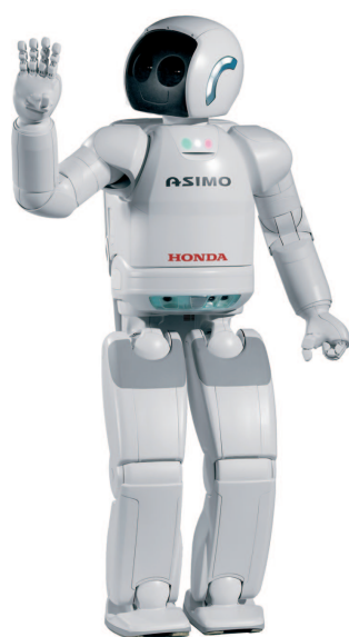
FIGURA 1. Exemples de robots controlats amb el criteri d'estabilitat local basat en la posició del ZMP: Honda ASIMO (a) i Sony QRIO (b).
