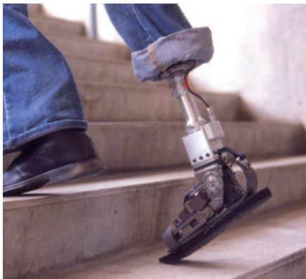
FIGURA 7. a) Pròtesi de turmell (MIT Biomechanics Group) i b) ortesi de turmell passiva (Spears Prosthetics & Orthotics).
