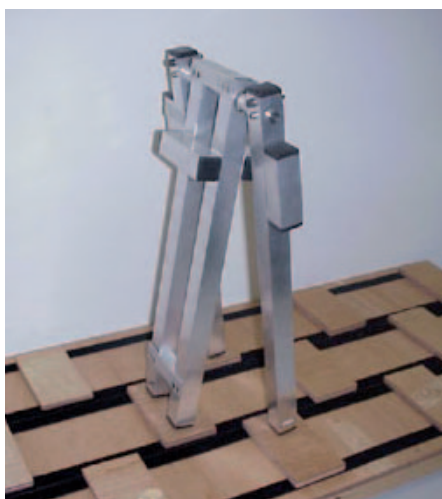
FIGURA 4. Mecanismes capaços de caminar pendent avall sense cap actuació ni control ( passive dynamic walking ): moviment bidimensional (a) i moviment tridimensional (b).
