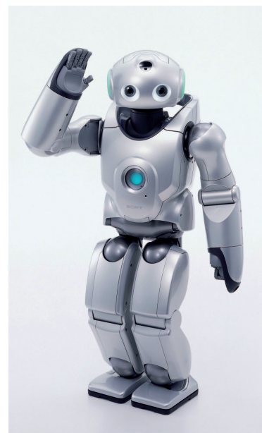
FIGURA 1. Exemples de robots controlats amb el criteri d'estabilitat local basat en la posició del ZMP: Honda ASIMO (a) i Sony QRIO (b).
