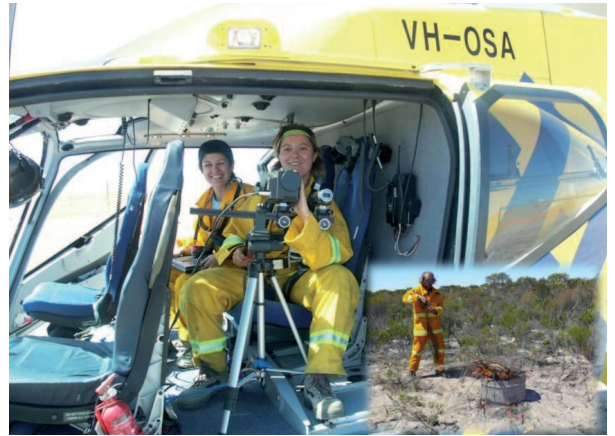
FIGURA 11. Helicòpter equipat amb càmera TIR i vídeo d'alta resolució. A la part inferior dreta, detall de les referències calentes utilitzades com a georeferències.
