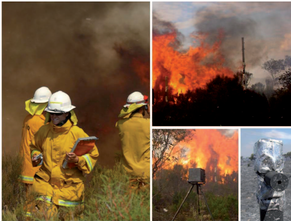
FIGURA 9. A l'esquerra, investigadors realitzant observacions in situ . A la dreta a dalt, torre amb sensors de flux de calor. A la dreta a baix, càmera de vídeo degudament protegida i sensor de flux de calor després d'haver-hi passat les flames.
