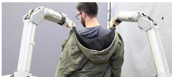
FIGURA 6. Prototip de robot bimanual d'ajuda a vestir, desenvolupat en el marc de l'ERC Advanced Grant CLOTHILDE, dedicat a la manipulació versàtil de roba mitjançant robots.
