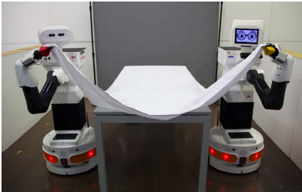
FIGURA 3. Els robots Clothi i Sòcrates col·laborant per estendre unes tovalleres en el marc de l'ERC Advanced Grant CLOTHILDE, dedicat a la manipulació versàtil de roba mitjançant robots. FONT: IRI, CSIC-UPC.
