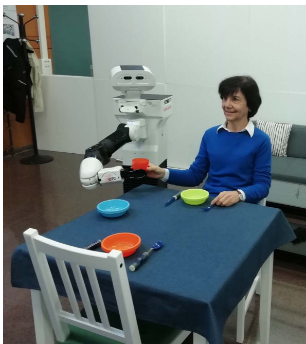
FIGURA 2. Prototip de robot assistencial, adaptat del robot TIAGO de PAL Robotics, utilitzat en la recerca duta a terme al Laboratori de Percepció i Manipulació de l'IRI.
