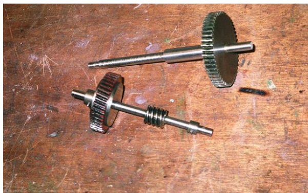
FIGURA 14. Conjunt dels dos arbres, un dels quals amb un vis sense fi, i els dos engranatges.
