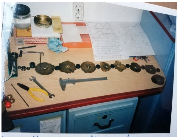
FIGURA 15. Taula de treball amb les eines i les lleves antigues de l'autòmat Pallasso i granota . Aquest és el moment en el qual es verifiquen les mides de les lleves i el seu desgast o erosió, i es valora si es refan de nou amb el mateix material o si s'aprofiten les antigues. La imatge prové d'una fotografia d'un dossier tècnic.
