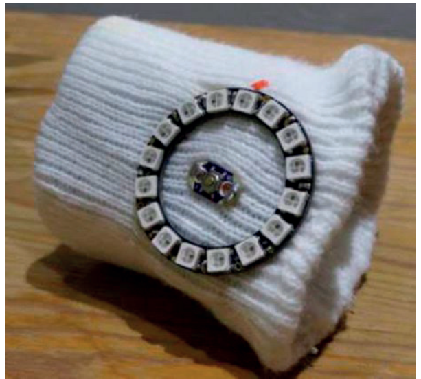
FIGURA 13. Canellera amb altímetre i brúixola dissenyada per uns estudiants del grau en tecnologies industrials. FONT: Arxiu dels autors..
