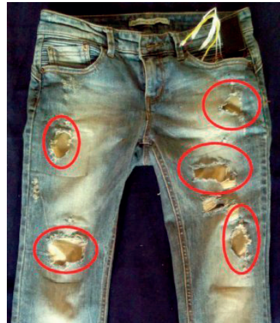
FIGURA 5. Pantalons per jugar al Simon dissenyats per estudiants del grau en tecnologies industrials. En la fotografia s'han encerclat les cinc zones tàctils. FONT: Arxiu dels autors.
