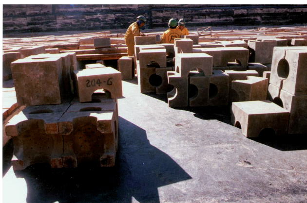
FIGURA 2. Aplicacions del formigó de sofre a l'empresa minera CODELCO (Xile): paviments, elements prefabricats i recobriments per a ambients corrosius.
