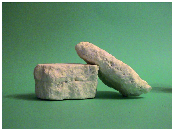
FIGURA 4. Mostra del sofre que es va utilitzar en el present projecte, provinent del refinatge del petroli.
