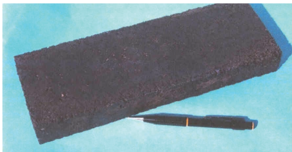
FIGURA 7. Rajola de formigó de sofre fabricada en el context del present projecte de recerca, com a demostració d'una possible aplicació.
