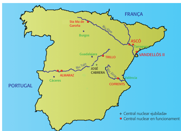
FIGURA 19. Vuit centrals nuclears actualment en operació a Espanya, i una central nuclear «jubilada» el passat 30 d'abril de 2006. La potència nuclear instal·lada a Espanya és de 7.736 MWe i representa el 23 % de l'electricitat produïda.
