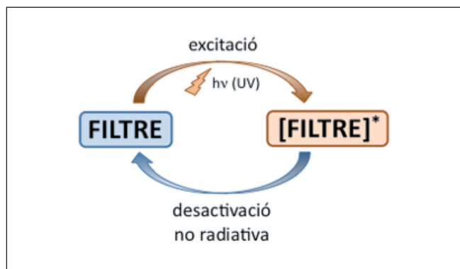
FIGURA 1. Esquema del funcionament d'un filtre solar.
