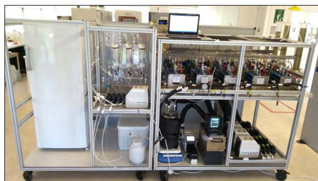
FIGURA 11. Prototip AD-MEC integrat amb contactors de membrana, per a la recuperació de biometà d'aigua residual saturada amb \text{CO}_2 . Fotografia dels autors.
