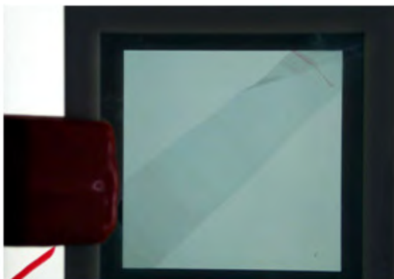
Fig. 3: Tira de plàstic isòtropa entre polaritzadors paral·lels
