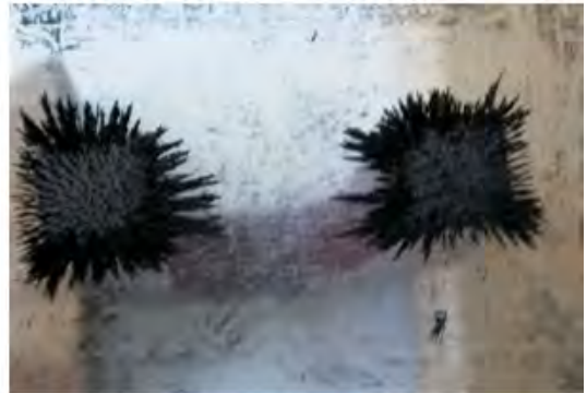
Fig. 4: Fotografies dels espectres magnètics d'un imant de barreta i d'un imant de ferradura, situats perpendicularment a la superfície on estan col·locades les partícules de tòner.
