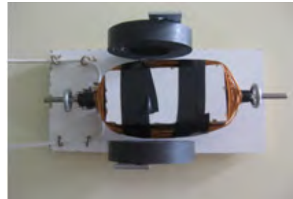
Fig. 2: Motor elèctric artesanal.
