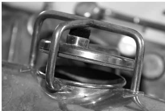
FIGURA 8b. Chimenea rebordeada en un saxofón original.
