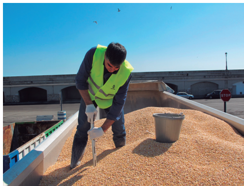
FIGURA 3. Inspector prenent una mostra representativa d'un camió de blat de moro amb una sonda
