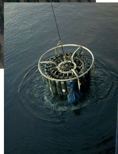
La Rossette o Biorosy és un aparell molt utilitzat per agafar l'aigua de la columna a diferents fondàries; acoblat porta un CTD, aparell que mesura temperatura, salinitat, fluorescència i turbidesa a l'hora que registra la fondària.
