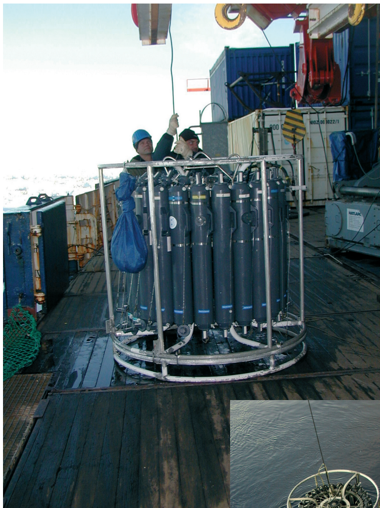
La Rossette o Biorosy és un aparell molt utilitzat per agafar l'aigua de la columna a diferents fondàries; acoblat porta un CTD, aparell que mesura temperatura, salinitat, fluorescència i turbidesa a l'hora que registra la fondària.
