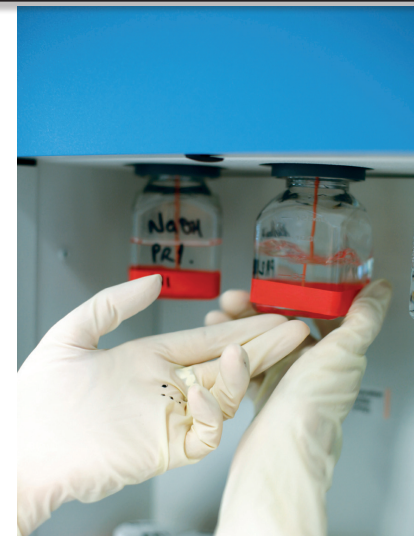
Detall de la càrrega de reactiu en un dels seqüenciadors de DNA
