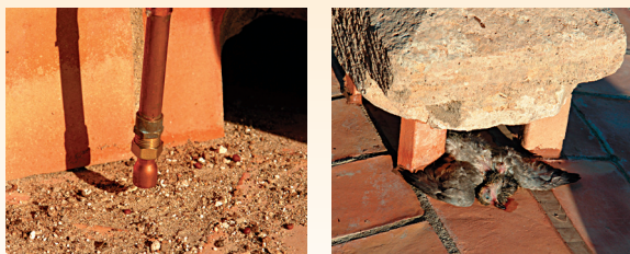
Sensor d'embassament a l'esquerra, on podem veure la boca de desaigüe que intentem monitoritzar. A la dreta, colom mort al sostre de la catedral, un dels múltiples factors que podrien embassar els desaigües.
