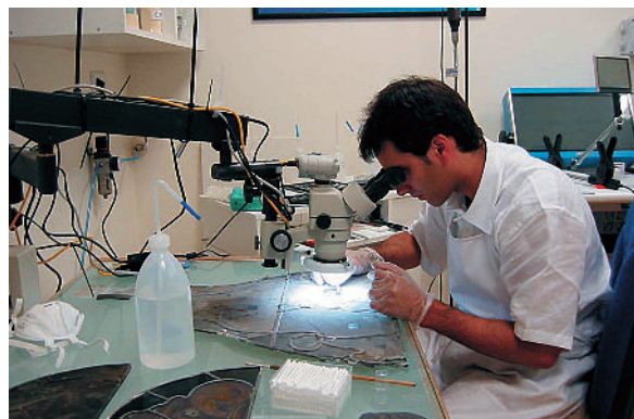
Alfonso Muñoz al laboratori. A l'esquerra, realitzant fotografies de la superfície del vidre amb un microscopi per a analitzar les patologies. A la dreta, netejant una peça mitjançant estereozoom.
