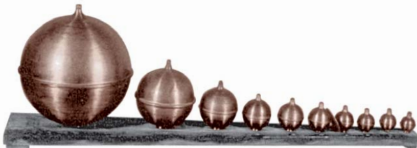
Ressonadors de Helmholtz, un instrument molt emprat per a l'ensenyament de l'acústica (Laboratori de Física General "Fernando Senent" de la Universitat de València, començaments del segle XX)
