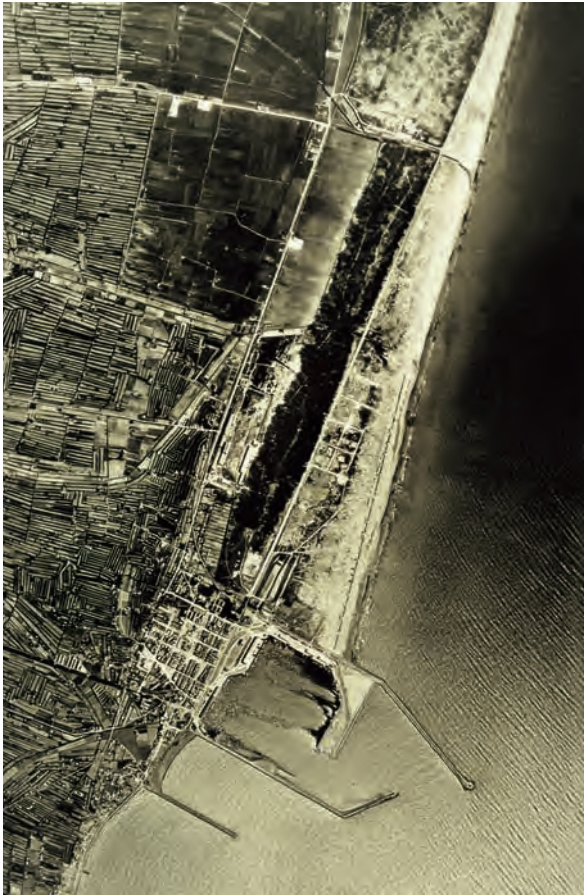
La dinàmica natural dels sediments al litoral valencià —de nord a sud— ha provocat un efecte d'acumulació d'arena al nord de les principals construccions, com és el cas del port de Castelló. Les fotografies aèries (a l'esquerra, de l'any 1956; i a la dreta, de 1983) mostren diferències significatives pel que fa a la distribució dels sediments. La platja del Pinar, just al nord del port, ha avançat més de 600 metres sobre la mar al llarg de l'últim segle.
