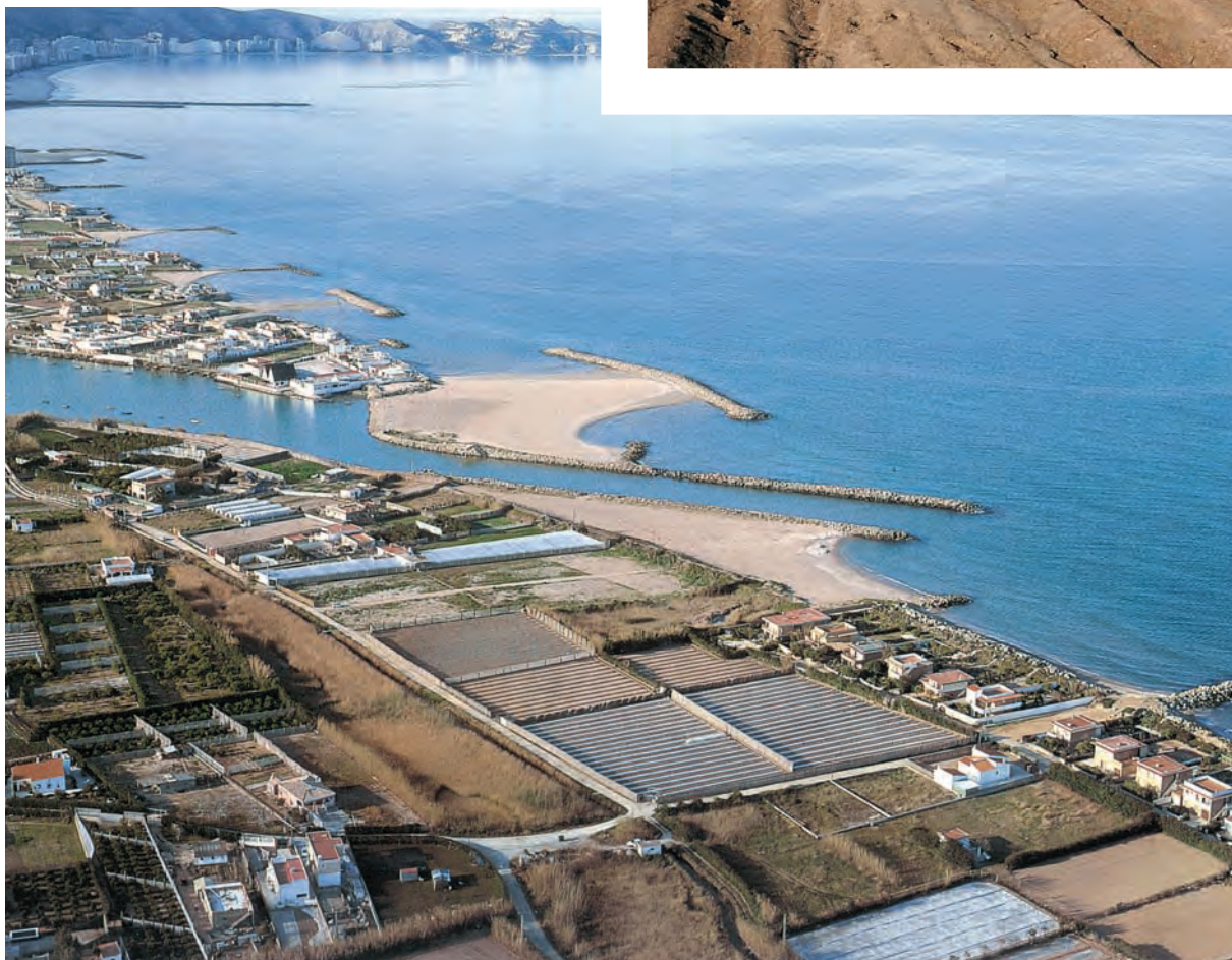
Fotografia aèria de la desembocadura del Xúquer al litoral de Cullera. La construcció d'espigons provoca una acumulació diferencial de sediments que artificialitza la franja costanera i que dona com a resultat un paisatge anomenat “dents de serra”.
