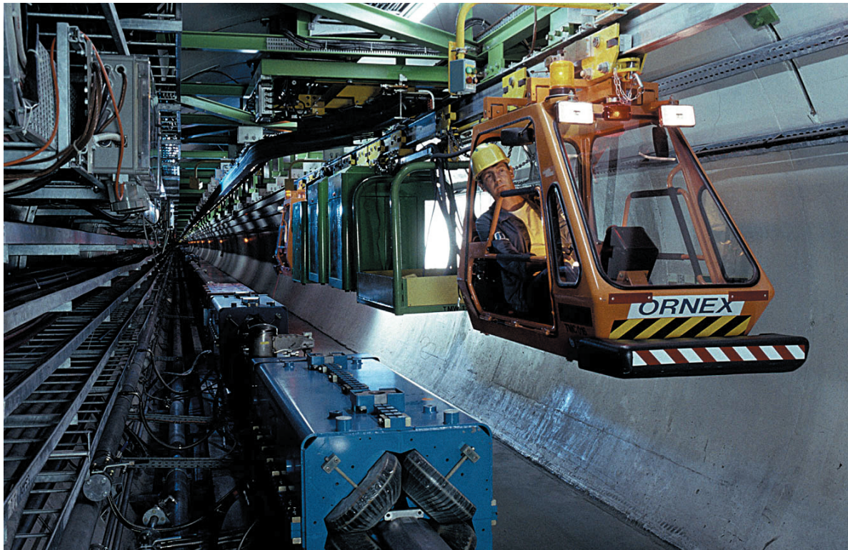
Figura 2: Interior del túnel de LEP. En la part de baix es veuen els diferents elements que componen l'accelerador (en blau en primer pla es veu un quadrupol), mentre que dalt apareix un home utilitzant el sistema de transport per a desplaçar-se per dins del túnel.
