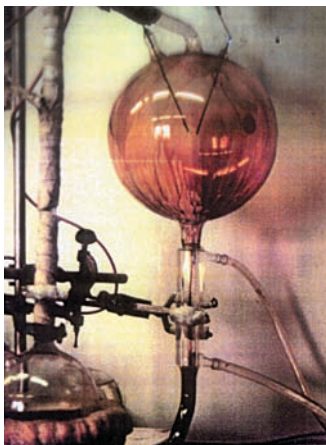
Aparell de Miller en funcionament. Durant l'experiment, explica Miller, l'aigua del matràs es tornà rosada el primer dia. Al final de la setmana la dissolució era d'un roig intens.
