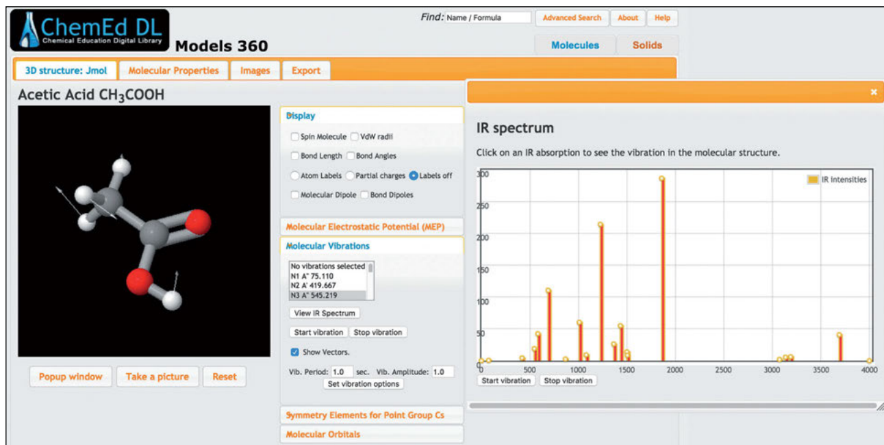
Figura 2. Models360: vibracions moleculars sincronitzades amb les línies de l'espectre infraroig.
