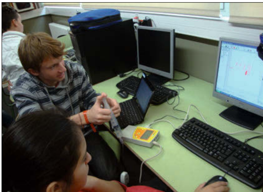
Figura 1. Experiment de variació de la pressió amb el volum de l'aire fent servir el sensor de pressió de la consola Multilab.
