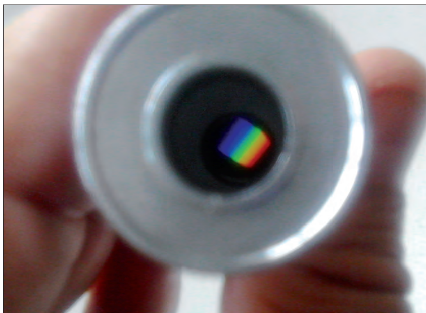
Figura 3. Espectro de la luz solar visto a través de un espectroscopio de bolsillo.
