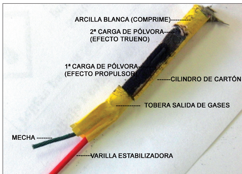
Figura 10. Interior de un pequeño cohete pirotécnico.
